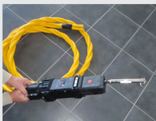
Kontrolle der Hilfskontakte und Leistungskontakte
