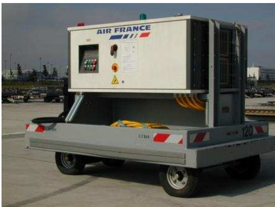
Convertisseur sur remorque avec câbles avion
